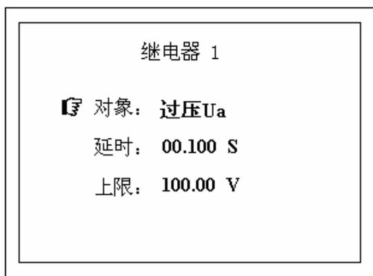
“继电器1”表示第1路输出开关量，按左键切换；当其对象选择“遥控”时，表示继电器输出类型为通信遥控；当其对象选择报警项目时，表示继电器输出类型为告警输出。首先通过“回车”键进入报警类型选项，再通过上下键进行报警菜单的选择，设完报警对象后按回车键确认；设置量值时先选中量值选项，再通过“回车”键进入量值选项设置阈值（通过左右键移动数字的光标位置，上下键实现数字的增减）。
