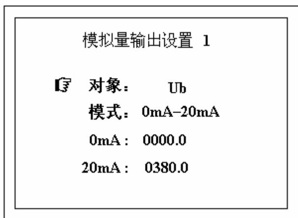
1、2表示第几路变送输出，每 1 路都可选择不同的变送项目。例如：第 1 路为 B相电压 0~ 380V 对应变送输出 0~20mA 的电流信号，另外1路变送可通过左键切换。注意：变送项目的量值（满刻度值）要设置准确，否则变送会不准，其数据格式（单位）详见附表模拟变送输出对照表。
